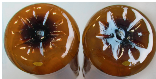
Bild 2. Fehlstellen in PET-Flaschen nach dem Streckblasen aufgrund kleinster Einschlüsse in den Preforms
